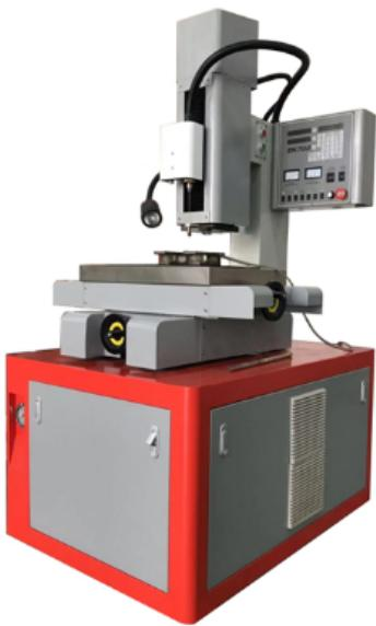
电火花穿孔机因其金属加工的灵活性，在广大机械行业中应用非常普遍，也备受好评！但是面对市场上众多种类的电火花穿孔机，很多师傅们也会比较迷茫，搞不清楚电火花穿孔机到底都能实现怎样的加工，那么，在这里给大家介绍几种典型的情况，供参考！工况一：批量穿孔 $\phi 0.3\text{--}3\text{mm}$ 速度和精度要求比较高、零件大小适中。对策：这种情况，适合用数控电火花穿孔机。首先选择合适的工装把零件批量装夹好、进行定位，再根据穿孔要求编程，由于三轴数控系统本身精度就高，所以标准化加工后的成品精度足以满足要求，速度也很快，可达 $60\text{mm/min}$ 。北京高速穿孔机价位苏州泰兰特进出口贸易有限公司始终以适应和促进工业发展为宗旨。
