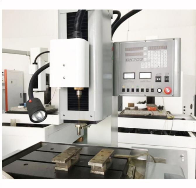
大家都知道现在生活中有比较多东西都是经过工业加工出来的，数控穿孔机是现在工业中比较火爆的一款机床，那么数控穿孔机到底可以加工什么呢？为什么那么多机床只有数控穿孔机的需求量多呢？要知道，现代的生活中，几乎所有的产品都离不开数控穿孔机的加工，打个比方，生活中常见的汽车，手表，电视机，冰箱，飞机等等，所有的零件都是要通过数控穿孔机来加工的。例如，航天发动机中特殊的材料位置复杂的深小孔加工，如叶片、火焰筒环形件等等都需要数控穿孔机来进行加工，关键是数控穿孔机还可以从工件的曲面穿入，更重要的是数控穿孔机加工的工件不受材料的限制，什么导电材料、不锈钢材料、硬质合金、温耐热等材料或者其他更难加工的材料，对于数控穿孔机来说都不是问题。因此，数控穿孔机这么受厂家的欢迎还是有原因的。
