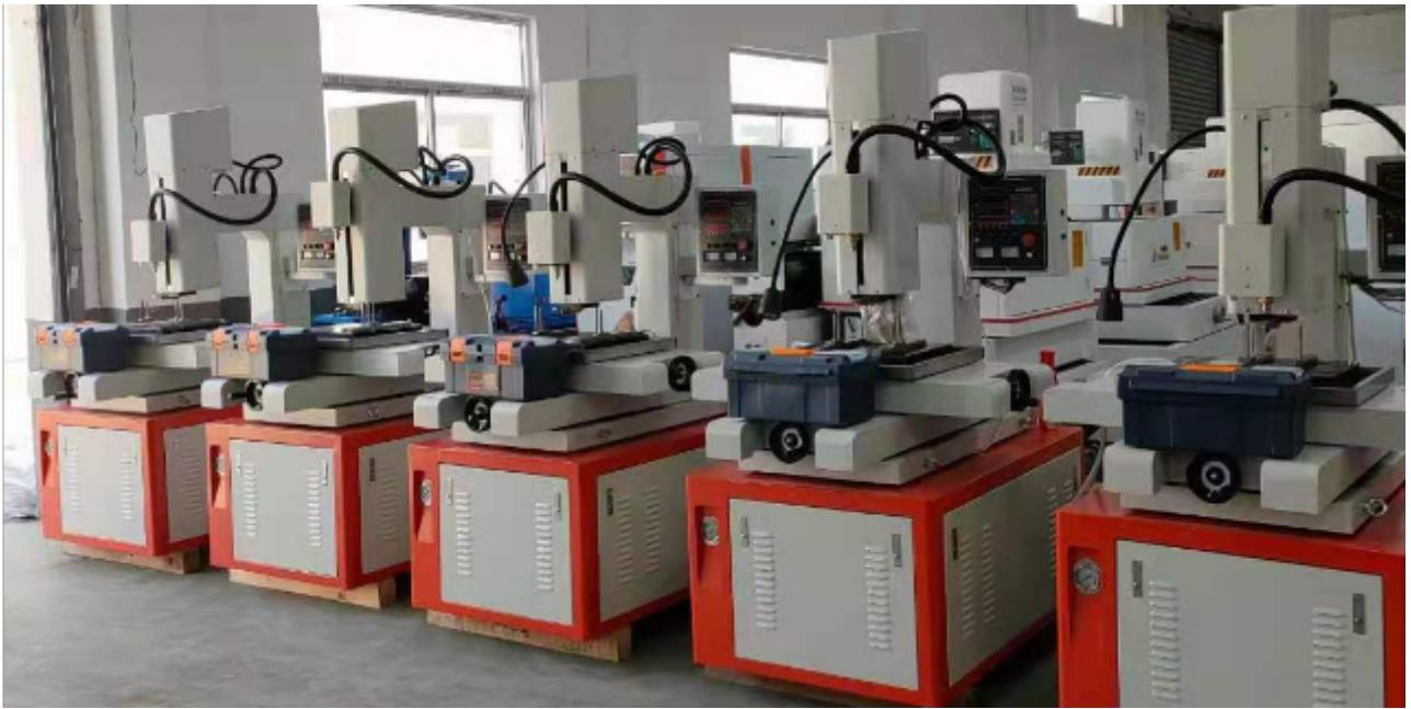
电火花打孔机的工作原理是利用连续上下垂直运动的细金属铜管作电极，对不锈钢、淬火钢、硬质合金、铜、铝等金属工件进行脉冲火花放电蚀除成型。细孔穿孔机可用于加工发动机中的冷却散热孔、筛板的群孔、液压气动元件的油路孔、油嘴油泵喷油孔、化织喷丝板的喷丝孔、线切割的穿丝孔等各种传统加工方法难于加工的深小孔。电火花打孔机根据应用的介质不同大致分为两种，一种是液体电火花打孔机，由于液体加工时要通过铜棒小孔，可能堵塞铜棒小孔，所以至小可加工0.15mm的细孔!深度也只能加工20mm是普遍应用的，另外一种是气体电火花打孔机，经过铜棒小孔的介质采用的是气体，所以不易被堵塞，可加工更精密的小孔。伺服系统是能够按控制命令的要求，对功率进行放大，移动和调控等处理。北京高速穿孔机价位
